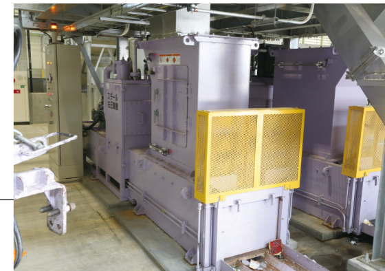
スチール缶・アルミ缶圧縮機 回収されたスチール缶やアルミ缶を別々に圧縮成型します。
