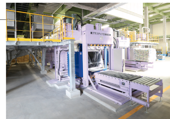
容器包装プラスチック圧縮梱包機 回収された容器包装プラスチックを圧縮し梱包します。
