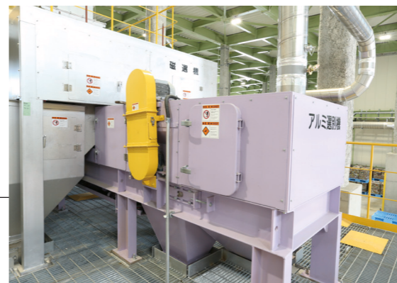
磁選機・アルミ選別機 磁選機は、電磁石を使って缶の中からスチール缶を選別します。アルミ選別機は、渦電流と磁界の作用による力を利用して、アルミ缶と異物を選別します。
